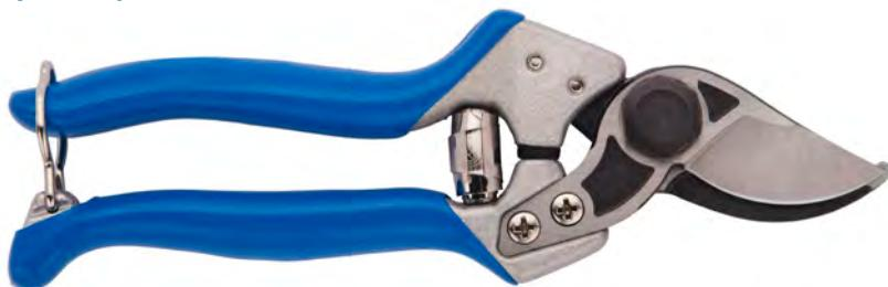
Forbice leggera e compatta dotata di lame più corte e rotanti in posizione eccentrica rispetto all'asse della forbice. Grazie a questi accorgimenti si ottiene una riduzione dello sforzo di taglio rispetto alle tradizionali forbici da vigna. Il ramo tende ad essere trascinato verso il fulcro di rotazione delle lame evitando così di sfuggire al taglio. Gruppo lame in acciaio al carbonio, forgiato a caldo e temprato.
