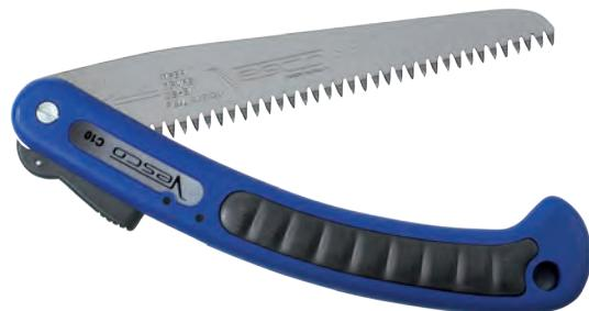
Sega a taglio tirante che assicura un taglio netto e preciso. La chiusura a serramanico la rende sicura e pratica. L'affilatura della lama è su tre lati e le punte sono temprate; ciò garantisce una durata e una resistenza della lama eccezionali. La superficie laterale della lama è liscia e migliora la scorrevolezza durante il taglio evitando infezioni del legno e garantendone una rapida cicatrizzazione. L'impugnatura in plastica bicomponente risulta molto confortevole e ne favorisce la presa.
