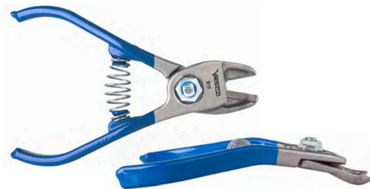
Forbici per la raccolta di agrumi e mele. Questo modello è progettato per evitare di lasciare lunghi steli nei frutti che hanno il peduncolo infossato. Le sue lame concave si adattano alla forma del frutto senza causare ferite sulla buccia del frutto. La curvatura delle impugnature consente alle forbici di avvicinarsi al peduncolo del frutto con l'angolazione più appropriata per eseguire il taglio.
