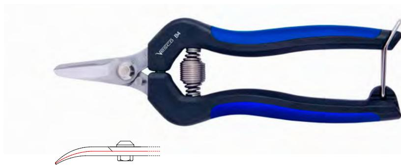
Attrezzo leggero e maneggevole con lame corte, affusolate e ricurve in acciaio inox temprato studiate appositamente per permettere una più facile raccolta e pulizia dei fiori. Particolarmente adatta anche per la raccolta degli agrumi. Manico ergonomico bi-componente: nylon e fibra di vetro con inserto in gomma antiscivolo. Finecorsa ammortizzato.
