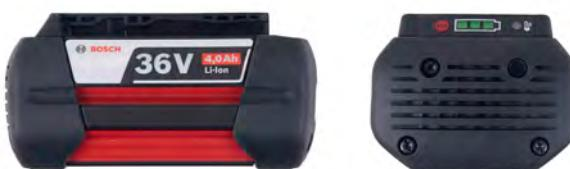
Potente batteria agli Ioni di Litio da 144Wh con tecnologia BOSCH CoolPack: Protezione ottimale delle celle dal surriscaldamento, grazie alla speciale carcassa che dissipa il calore verso la parte inferiore per una vita utile incrementata fino al 100%\* e un'autonomia superiore fino al 100%\*. Ricarica rapida: le batterie al litio da 4,0 Ah sono caricate all'80% dopo soli 25 minuti. Nessun effetto memoria e nessun calo di potenza. Le batterie più compatte e più leggere esistenti sul mercato.
